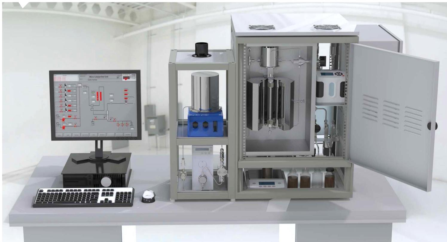
**Каталитическая Установка (МСВ) – это система с реактором, специально предназначенная для удовлетворения потребностей учебных, научных и заводских лабораторий в оценке катализаторов и разработке каталитических процессов.**
