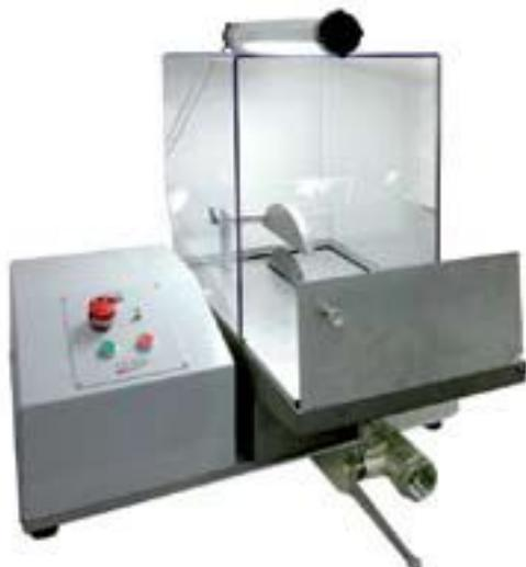
Предназначен для ручной резки небольших образцов породы до требуемых размеров. Прозрачный кожух обеспечивает защиту от брызг. Лампа подсветки дает хорошую видимость в зоне резки.
