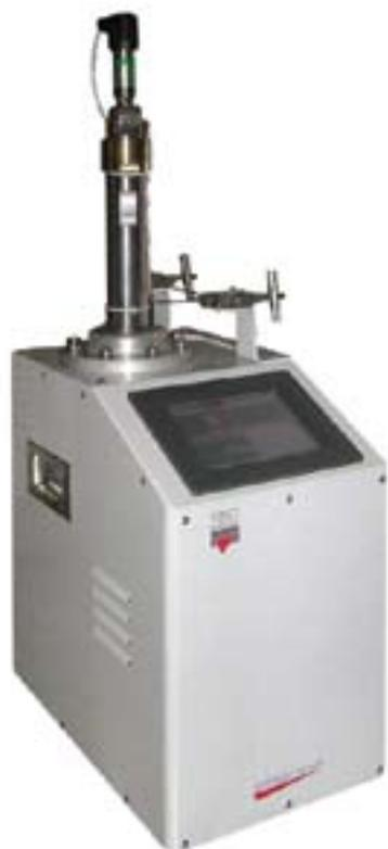
Модуль включает регулятор противодавления игольчатого типа, предназначенный для поддержания заданного порового давления на образце керна. Регулятор оснащен камерой, которая заполняется газом для демпфирования скачков давления инжектируемых флюидов. Давление задается при помощи автоматизированного 1-цилиндрового насоса с компьютерным управлением.
