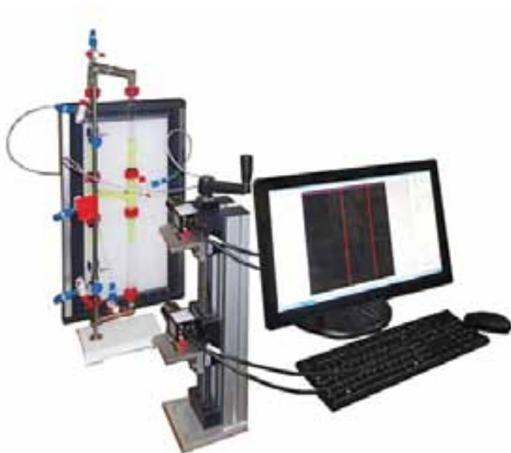
Предназначен для разделения флюидов, поступающих в ходе эксперимента по определению трехфазной проницаемости образца керны, и точного измерения их объемов.
