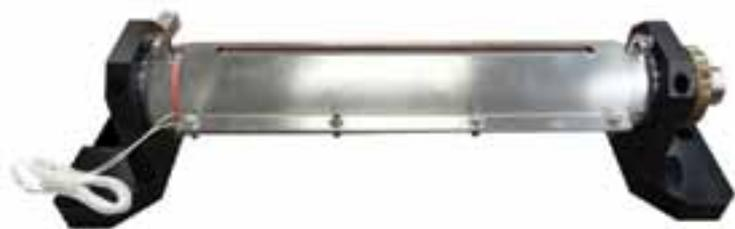
Рентгенопрозрачный кернодержатель по конструкции представляет собой гидростатический кернодержатель. Однако он изготавливается из титана и имеет минимальную толщину стенок для оптимизации прохождения рентгеновского излучения. Это позволяет использовать серию ТХС в установках, где насыщенность образца отслеживают в реальном времени при помощи рентгеновского аппарата.
