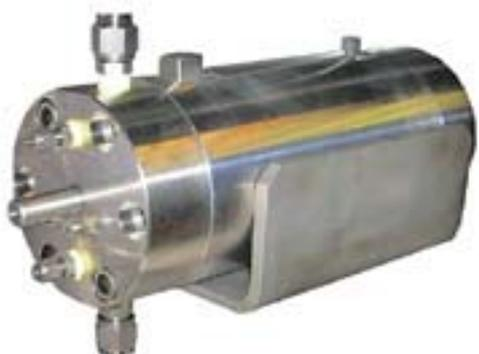
Используется в основном при стационарном и нестационарном режиме фильтрации жидкостей через образец керна в ходе изучения эффектов эрозии, вызываемой омытием торцов образца жидкостью, содержащей жидкость для гидравлического разрыва пласта и другие компоненты. Схема кернодержателя предусматривает возможность омытия торца образца породы подаваемой жидкостью. Жидкости могут подаваться одновременно через оба порта головки кернодержателя. Таким образом моделируются условия скважины.
