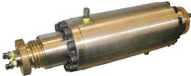
Стандартный кернодержатель, используемый в экспериментах по фильтрации флюидов через образец керна. Образец помещается в манжету, которая устанавливается в кернодержатель. Крышка кернодержателя закручивается специальным ключом. Одновременная подача флюидов осуществляется через входные порты кернодержателя. Поступающая смесь флюидов после фильтрации выводится через выходной порт кернодержателя.
