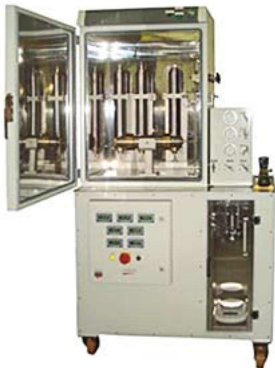
Установка позволяет инжестировать раствор кислоты в образец керна при пластовых условиях. При этом в образце растворяется часть минералов, в результате чего повышается проницаемость. В ходе эксперимента можно построить график падения давления в зависимости от объема инжестированной кислоты, скорости потока и температуры и подобрать оптимальный режим обработки скважины.
