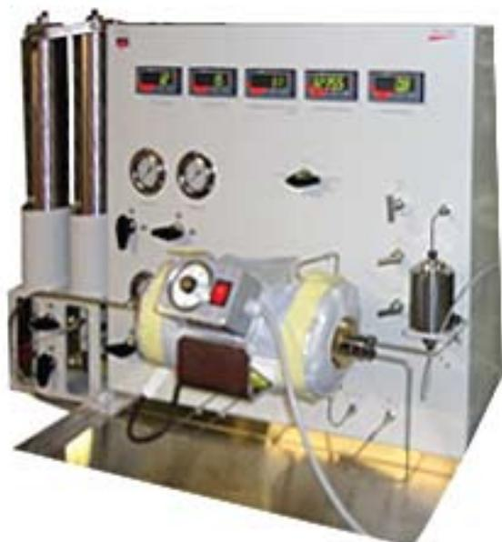
Установка является бюджетным решением для изучения фильтрации флюидов при пластовых условиях. На установке можно моделировать вторичные и третичные методы повышения нефтеотдачи, а также можно определять относительную проницаемость при остаточном насыщении образца вторым флюидом и эффективность вытеснения. Система дополняется линией инъекции газа, автоматическим коллектором фракций и шкафом с воздушным термостатом.
