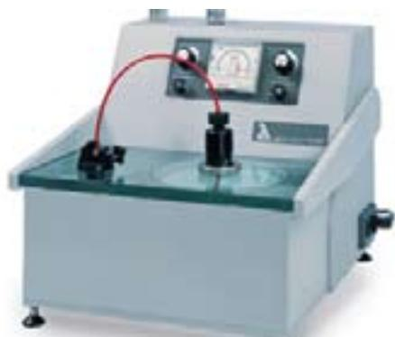
Предназначен для дегазации и стабилизации смолой порошкообразных, сломанных, хрупких, рыхлых образцов.
