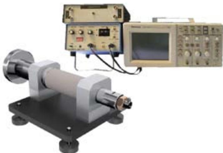
Позволяет измерять скорость распространения акустических волн в образце керна при атмосферном давлении и температуре окружающей среды.
