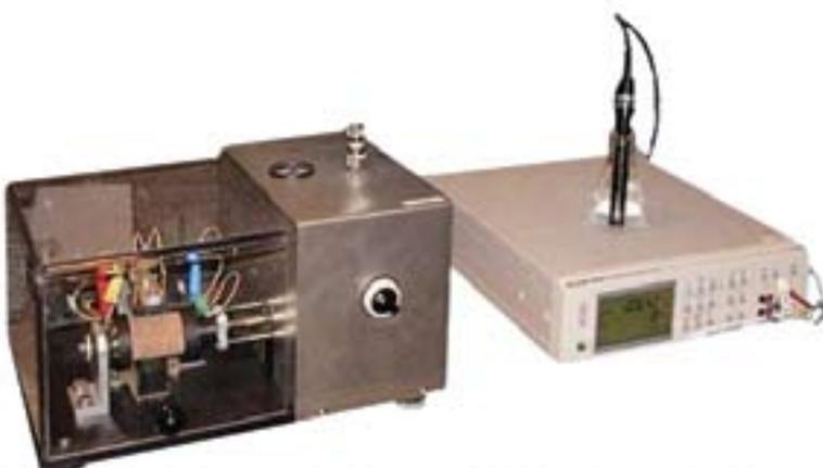
Предназначена для измерения сопротивления частично или полностью насыщенного образца керна при атмосферных условиях. Система обеспечивает измерение сопротивления горных пород при различных частотах и сопротивлении солевого раствора. Конструкция измерительной ячейки позволяет использовать двух- или четырехэлектродную схему. Для измерений используется RCL-измеритель.
