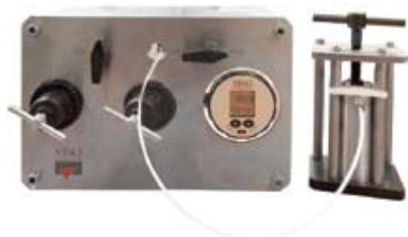
Предназначен для измерения капиллярного давления одного образца консолидированного керна методом полупроницаемой мембраны. Камера капилляриметра выполнена из нержавеющей стали и снабжена керамическими полупроницаемыми мембранами.
