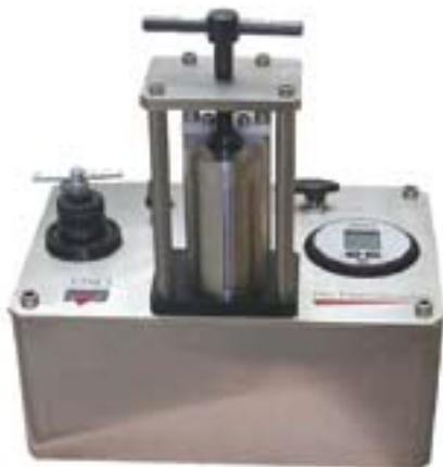
Предназначен для прямого измерения скелетного и порового объемов образца в измерительной камере при изотермических условиях. Принцип действия основан на законах Бойля-Мариотта и Шарля. Поставляемая с прибором компьютерная станция позволяет записывать результаты измерений, рассчитывать пористость и плотность зерен и другие параметры, а также данные калибровки. Все расчеты на основании полученных данных производятся с помощью простого и удобного Excel-шаблона.
