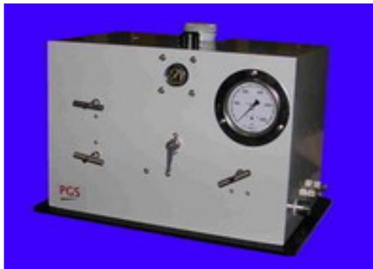
Предназначен для обеспечения гидравлического давления для безртутной подачи нефти из сосуда с плавающим поршнем в PVT ячейку при давлениях пласта. Максимальное давление выхода - 10000 пси. Система дополняется клапанами управления, насосом, панелью управления и емкостью.
