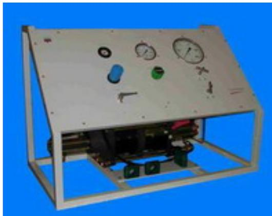
Установка предназначена для сжатия образца газа низкого давления в баллоне или PVT ячейке до высокого давления. Полностью готова к работе. Система комплектуется регулирующими клапанами, насосом, манометрами, регулятором давления, панелью управления и корпусом.
