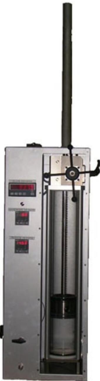
Газометр предназначен для точного измерения объема газа при температуре окружающей среды и атмосферном давлении и имеет ручной механизм управления перемещением поршня. Газ под давлением поступает в калиброванный цилиндр прибора, в котором скользит газонепроницаемый поршень, создающий камеру с переменным объемом, и заставляет плавающий поршень перемещаться вверх, таким образом, увеличивая внутренний рабочий объем цилиндра.
