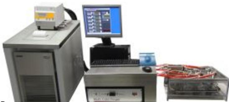
В аппарате для исследования по методу «холодного стержня» (cold finger) реализуется быстрый метод отбора для выявления и ранжирования потенциальных ингибиторов отложения парафинов. Количество парафина, осевшего на охлаждаемой поверхности, определяется количественно. Таким образом, может быть оценена эффективность ингибиторов образования отложений. Если температура нефти падает ниже температуры появления парафина или ТНКП (WAP / WAT), парафин обычно осаждается на стенках трубопровода.
