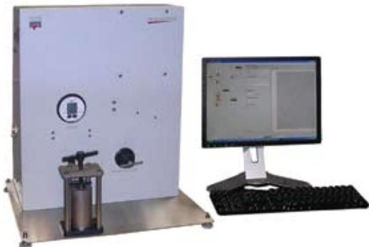
Предназначен для прямого измерения скелетного и порового объемов образца в измерительной камере при изотермических условиях. Принцип действия основан на законах Бойля-Мариотта и Шарля. Поставляемая с прибором компьютерная станция позволяет записывать результаты измерений, рассчитывать пористость и плотность зерен и другие параметры, а также данные калибровки.
