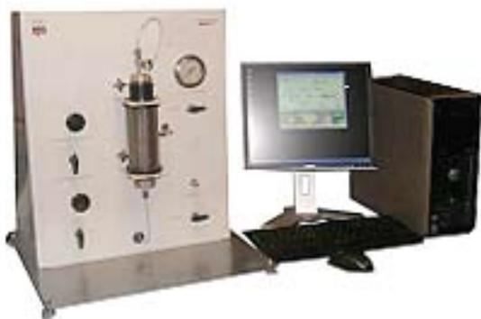
Предназначен для измерения газопроницаемости образцов керна при комнатной температуре и пластовом давлении обжима. Прибор снабжен компьютерной станцией для сбора данных и выполнения расчетов при работе как в ручном, так и в автоматическом режиме. Измерение проницаемости по воздуху выполняется при стационарной фильтрации. Прибор обеспечивает инжекцию газа через образец при различных значениях давления и расхода.
