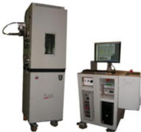
FlasS ®анализатор включает три главных методики, которые были разработаны для исследования явлений осаждения твердых частиц в пробе пластового флюида.
